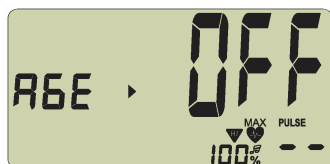
Рис. 10. Нет введенной информации ("OFF"), но есть символ ноты (♪), что означает появление звукового сигнала, когда пульс превысит максимальное значение.
